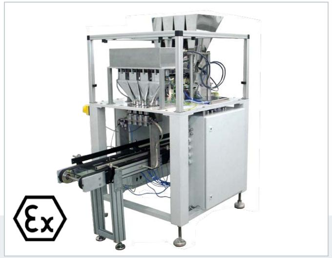
**Ex 706-4:** La balance multiple linéaire dose les granulés explosifs de 30.000 mg avec une précision de  $\pm 3$  mg à une cadence d'environ 25 pesages/min.
