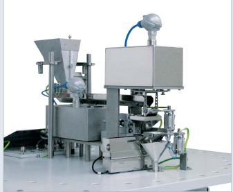
Die Waage Ex 703 füllt beispielsweise Explosivstoffe in Airbag-Gasgeneratoren. Diese kann auch mit einer Explosionsglocke geliefert werden.
