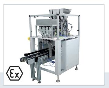
Ex 706-4: Die lineare Mehrfachwaage dosiert Sprengstoffgranulate von  $30.000\,\text{mg}$  mit einer Genauigkeit von  $\pm$  3 mg bei einer Leistung von ca. 25 Wägungen/min.
