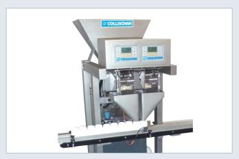
Zwillingswaage S 706-2 mit automatischer Füllstation für höhere Leistung. Bei Bedarf kann die Maschine mit beliebig vielen Wägeköpfen ausgestattet werden.
